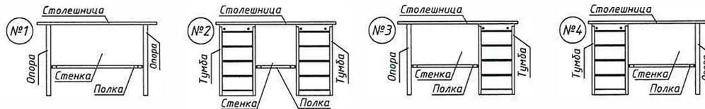
! Определите схему сборки для Вашего верстака
