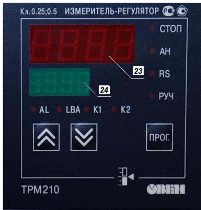
Рис.3. Лицевая панель измерителя-регулятора TPM210.
